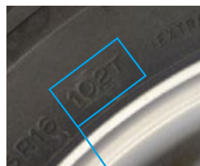
Siffrorna anger belastningsindex och bokstaven hastighetsindex.
