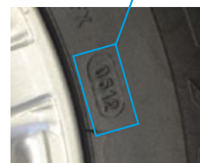
DOT-nummer anger vecka och år som däckets tillverkades
